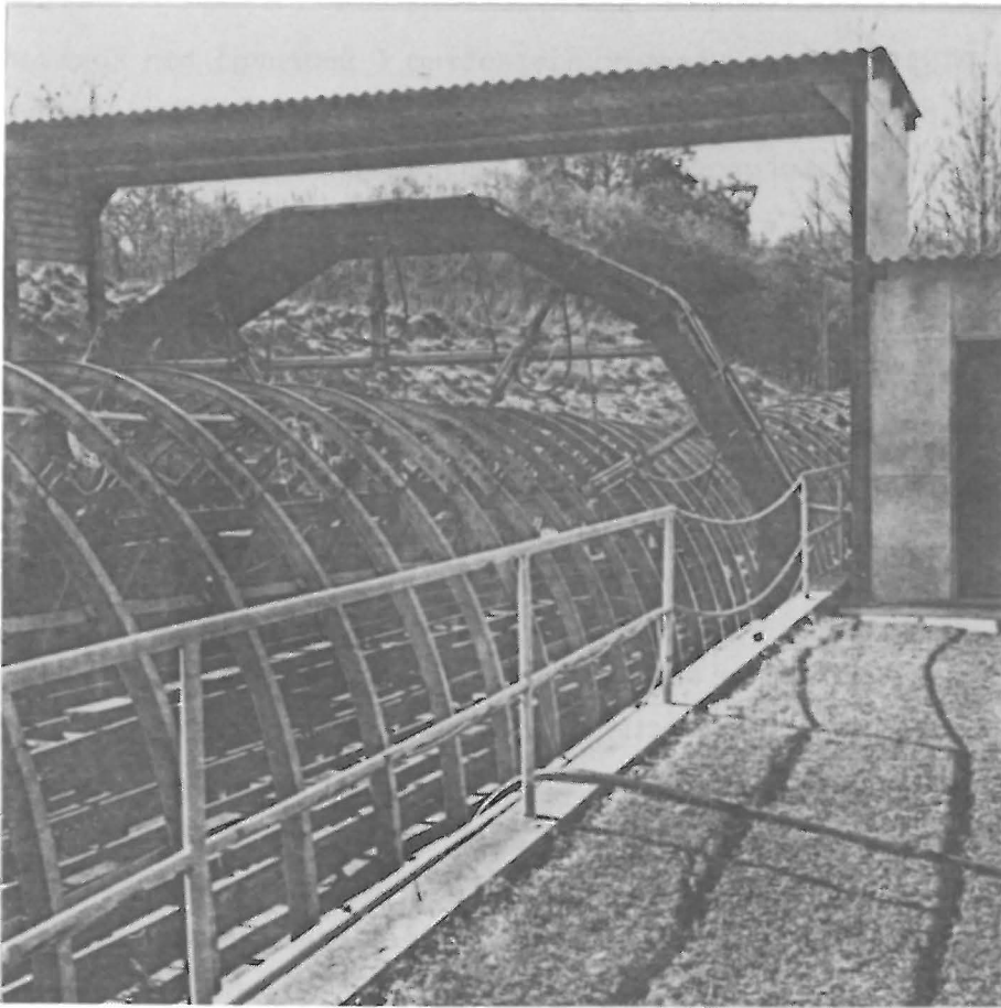
Bild 1: Prüfbahn mit Belastungseinrichtung für Ausbaubögen (Außenansicht)
