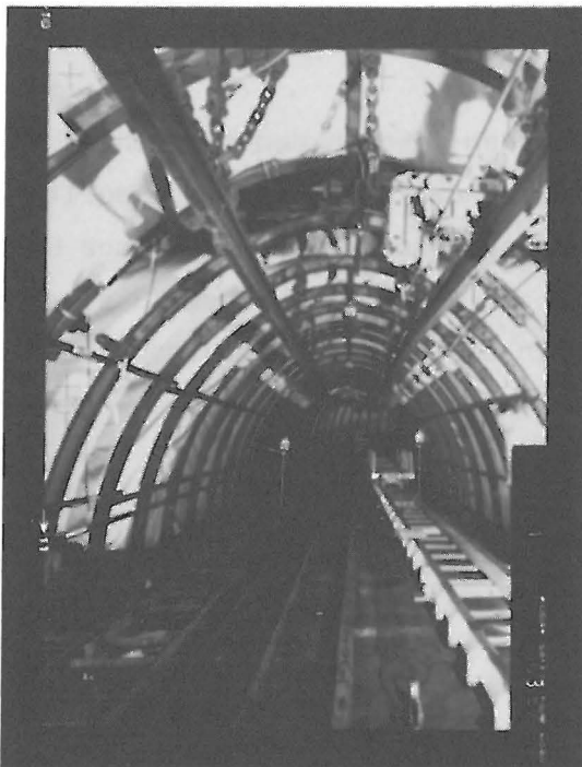
Bild 1: Prüfbahn mit Belastungseinrichtung für Ausbaubögen (Außenansicht)
