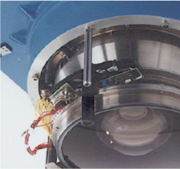
Bild 7.31: Sensorkopf des Navigationsautomaten nahe des Objektivstutzens der RMK TOP
