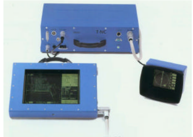
Bild 7.38: Navigationscomputer T-NC mit Touch-Screen-Display des Navigators und Pilotendisplay
