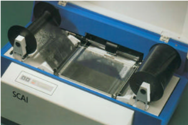
Bild 12.7: Rollfilmzusatz (Autowinder) des SCAI (geöffnet)
