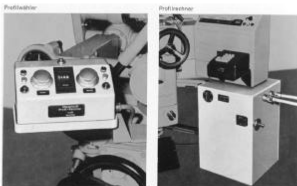
Bild 10.39: Profiwähler am C 8 und Profilrechner zwischen C 8 und motorischem Antrieb am Z 2
