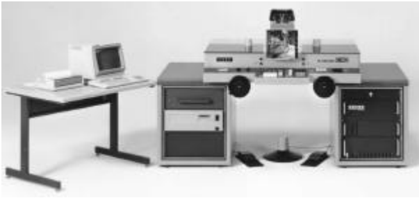
Bild 11.29: PLANICOMP C 140 mit HP 1000 A 600 Computer, ohne Schranktüren (1985)
