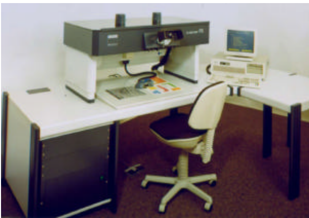
Bild 11.51: PLANICOMP P 3 mit PC-Software P-CAP (1989)
