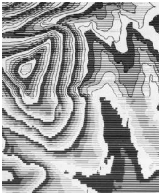
Bild 8.17: Höenschrafftenplan des GZ 1, teilweise bereits mit abgeleiteten Höhenlinien
