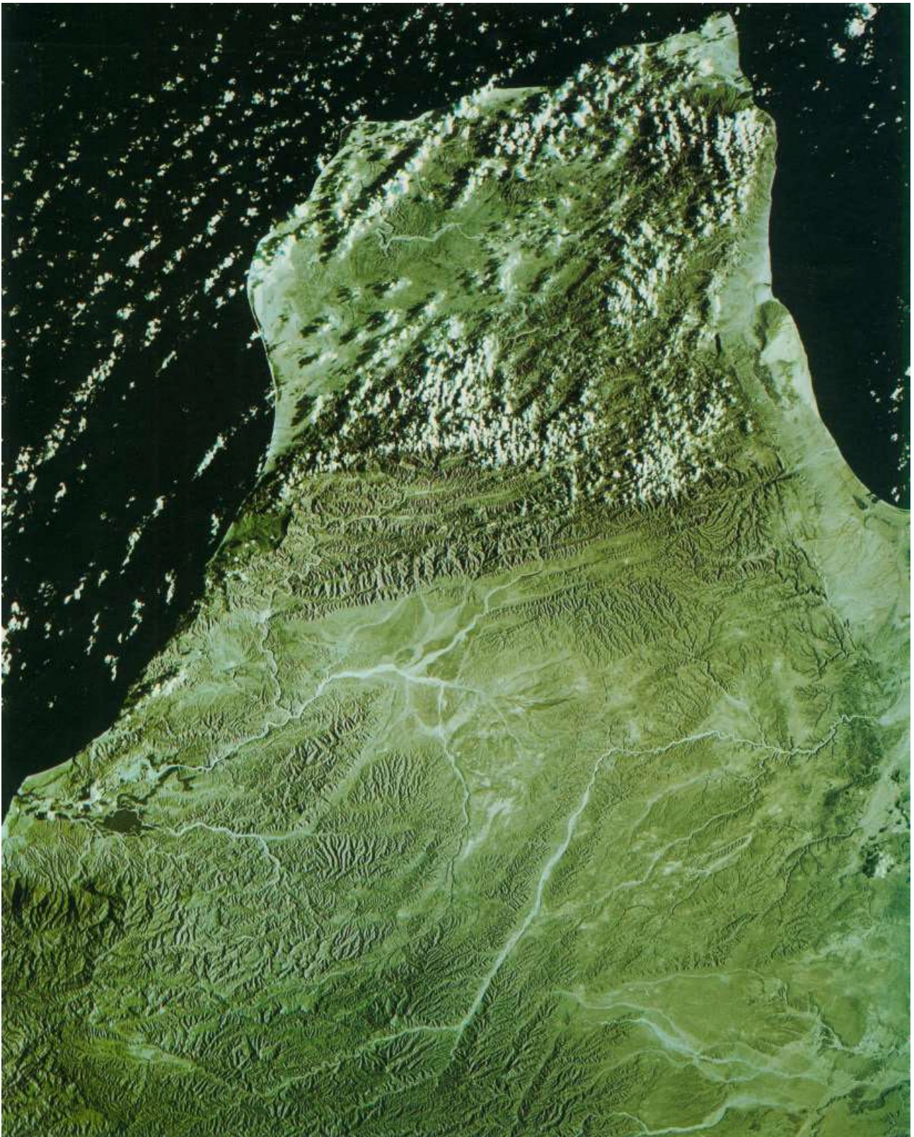
Bild 7.24: Das "Horn von Afrika", aufgenommen mit der ZEISS RMK A 30/23 (METRIC CAMERA) auf KODAK Infrarot-Farbfilm beim Spacelab-Flug vom 28.11 bis 08.12.1983 (Photo: ESA/DFVLR)
