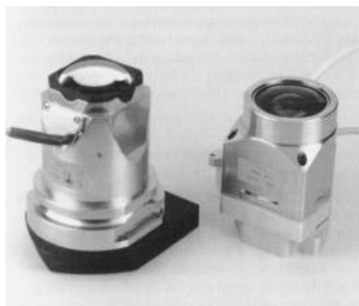
Bild 7.41: Kameraköpfe für die panchromatischen Kanäle (links) und für die Farbkanäle (rechts)
