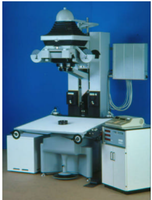
Bild 5.18: SEG 6 mit geöffneter Elektrik an der Säule und Orientierungseinrichtung OCS 1
