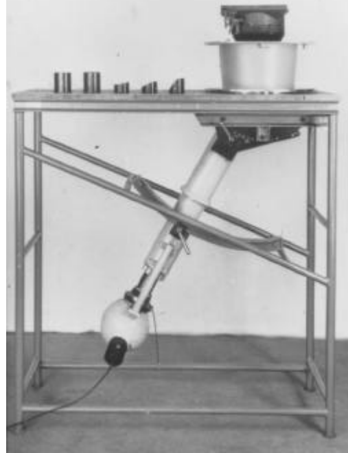
Bild 7.50: Kollimator zur Auflösungsmessung bei CARL ZEISS, Oberkochen
