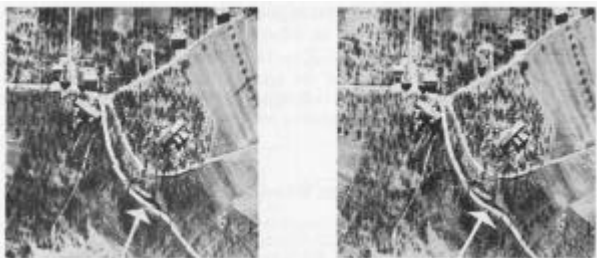
Bild 8.15: Bildverbesserung durch optische Interpolation (Ausschnitt mit und ohne Klaffen)
