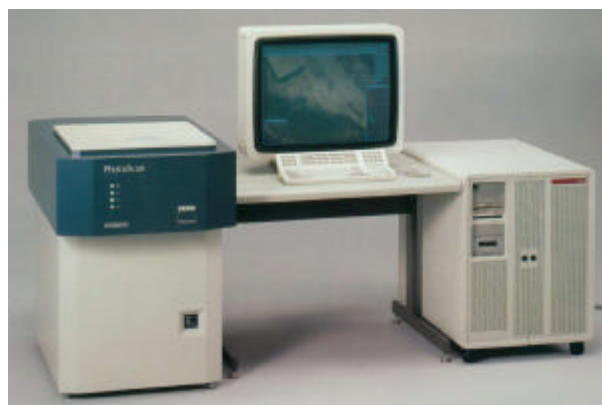
Bild 12.1: PHOTOSCAN PS 1 mit Workstation von INTERGRAPH
