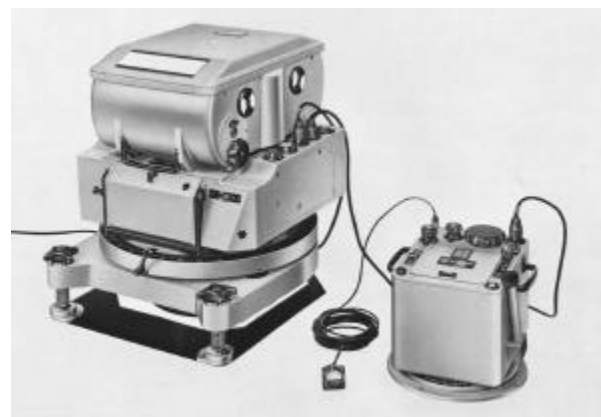
Bild 7.2: RMK A 15/23 in Aufhängung AS II und mit IRU sowie Auslöseanzeige für den Piloten (1961)
