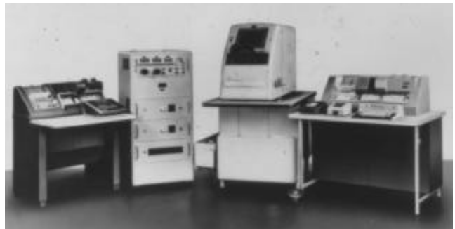
Bild 9.32: Präzisions-Einbildkomparator PEK mit Kartenlocher und motorischer Koordinaten-Voreinstellung vom Lochkartenleser
