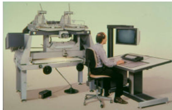
Bild 10.62: INTERGRAPH-Workstation am PLANICART E 3 mit Einspiegelung (1982)
