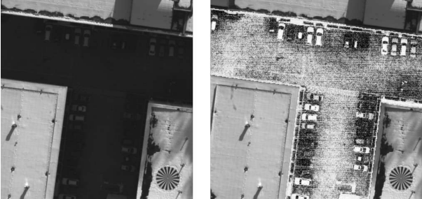
Bild 7.43: Beispiel für den Dynamik-Gewinn der CCD-Technologie (im Beispiel 10 bit) gegenüber Film
