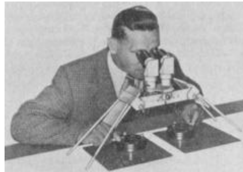
Bild 9.41: Übertragung eines künstlichen Punktes unterm Stereoskop
