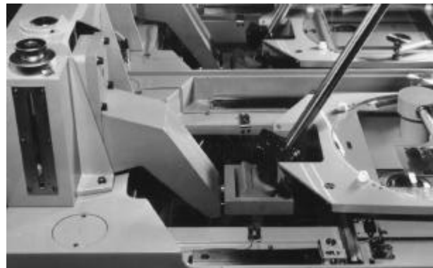
Bild 10.22: Optionale Kardan-Arme zum PLANIMAT für die Auswertung kurzer (terrestrischer) Brennweiten
