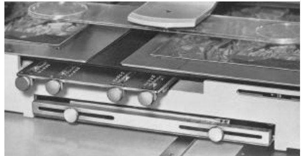
Bild 5.3: Einstellschrauben E1 bis E4 des Modellrechners I und Lagerechners II a
