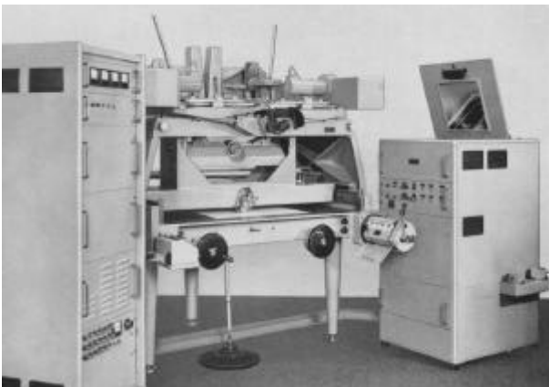
Bild 8.22: PLANIMAT mit Profilspeichergerät SG 1 und Elektronischem Korrelator ITEK EC 5
