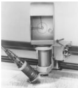
Bild 10.38: Einstellprojektor am Z 2 mit 10-facher Vergrößerung
