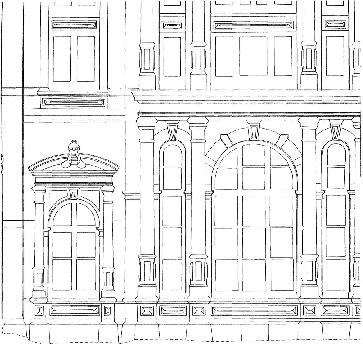
Fassadenauswertung 1 : 50: Rollei und Contax im Vergleich
