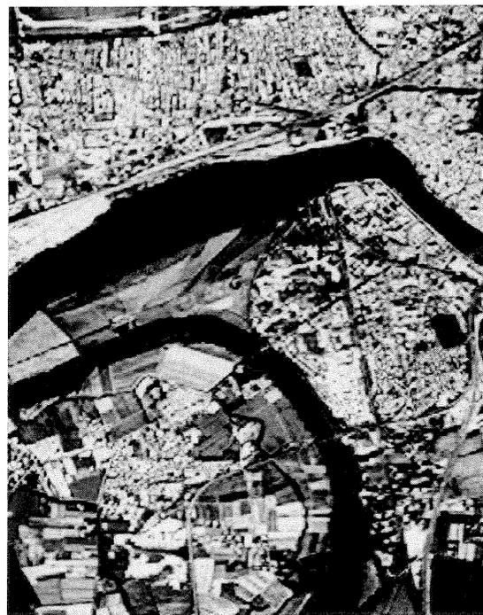
(D) Combinaison des images panchromatique HRV-1 et multispectrale HRV-2 après correction de la FTM sur les deux images.
