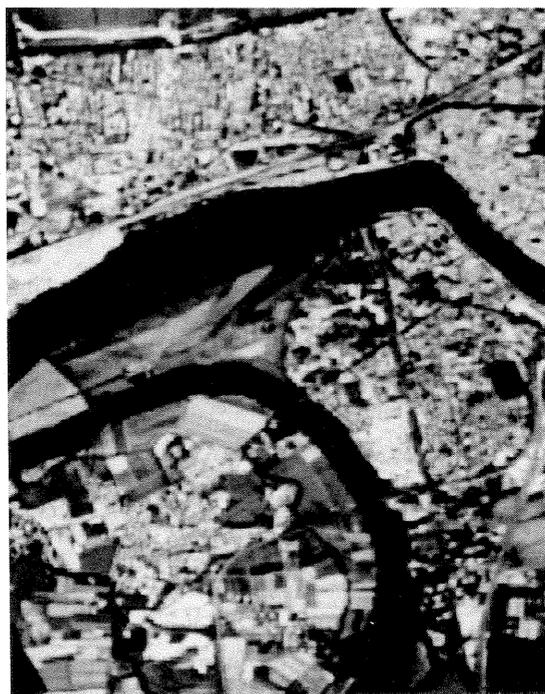
(C) Combinaison des images panchromatique HRV-1 et multispectrale HRV-2 sans correction de la FTM;
