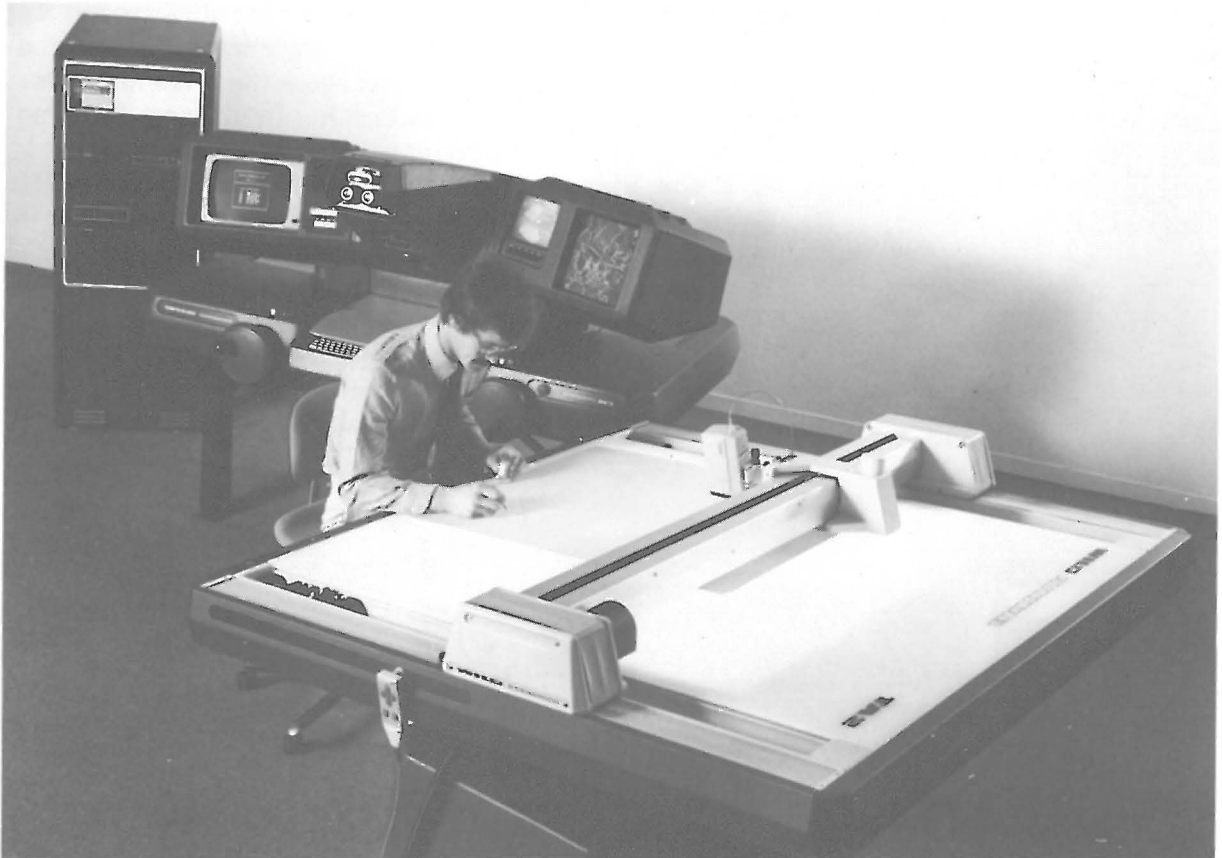
Bild 2 Der TA 2 in horizontaler Lage. Der Operateur führt Korrekturen auf der durchleuchteten Gravurfolie aus.
