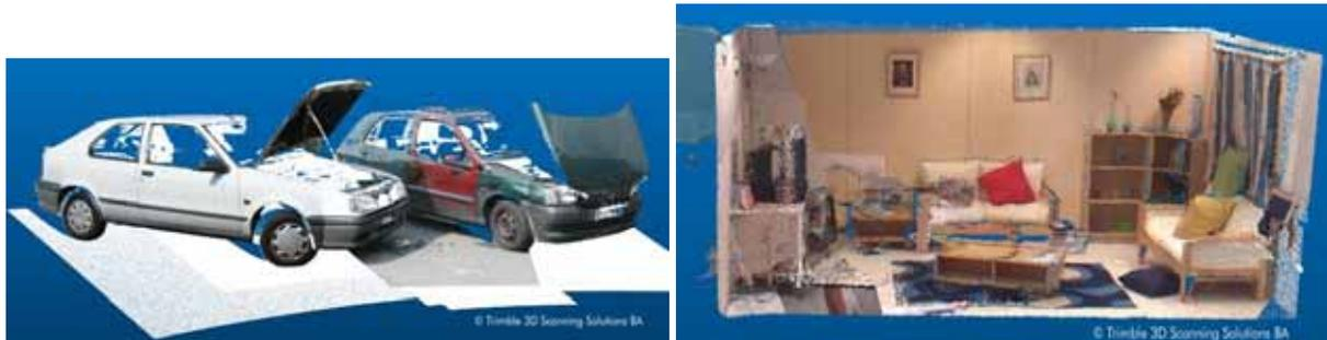
Figura 6: Resultados del escaneo láser de un accidente automovilístico y de una escena de crimen.
