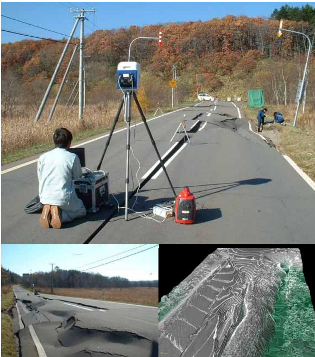
Figura 5. Hokkaido, Japón, levantamientos láser de una carretera después de un temblor, y los resultados obtenidos.
