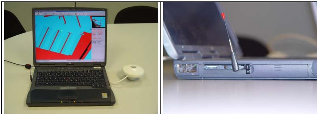
Figura 3: ordenador portátil embarcado y tarjeta de conexión GPRS
