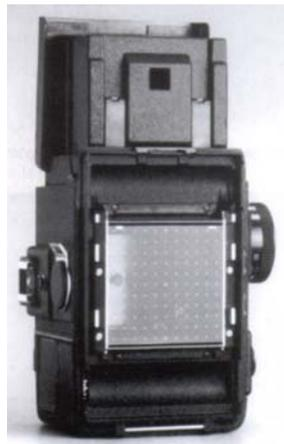
Figura 3: Cámara semimétrica Rollei 6006
