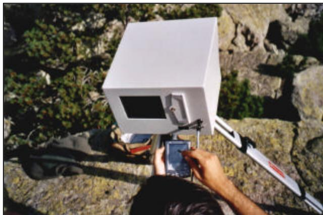
Figura 6: Imagen del láser escáner, con la PDA, que permite conectar con el equipo y modificar los parámetros.
