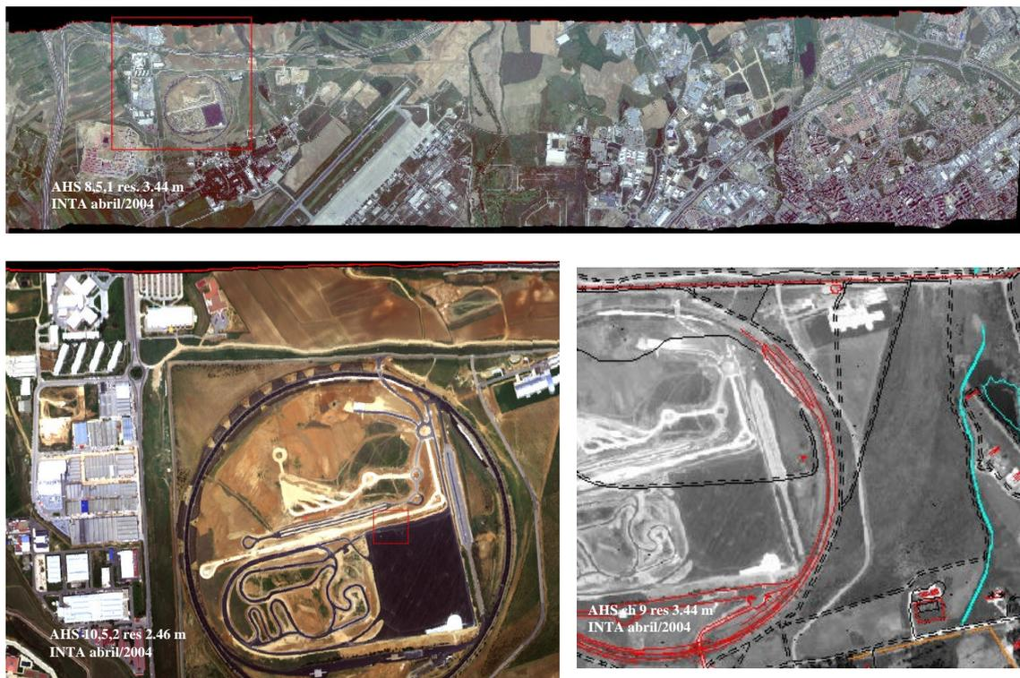
Figura 7. Imágenes AHS ortorectificadas sin GCP's. P1A (superior) y detalles (inferior).
