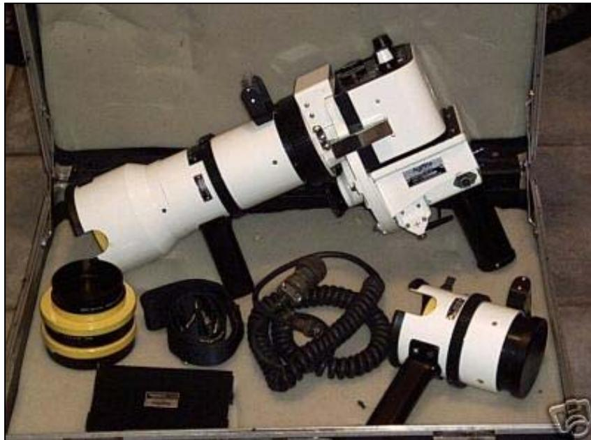
Imagen 2: Cámara aérea de formato 70 mm con objetivo Zeiss Sonnar de 350 mm
