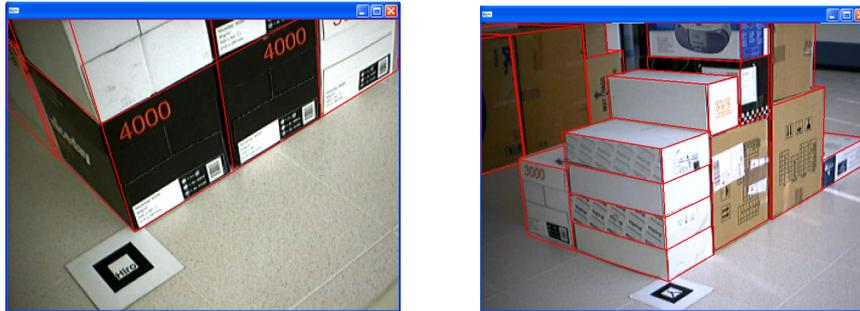
Figura 8. Emparejamiento de imágenes del apilamiento con el modelo CAD
