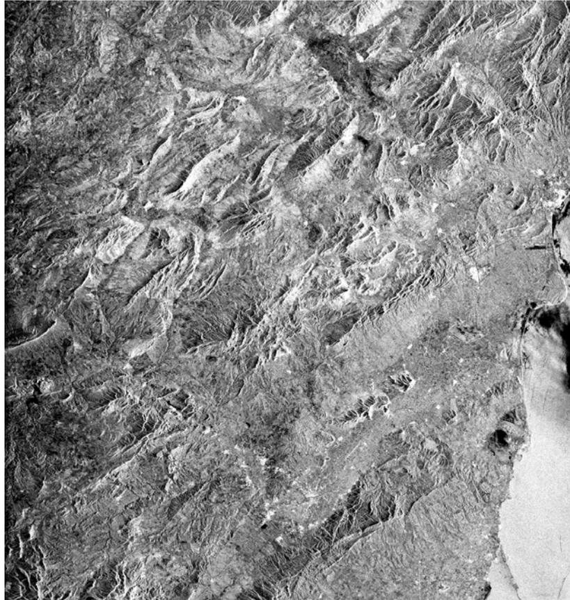
Figura 3: Media de amplitudes de la región de Murcia y alrededores, realizada a partir de 24 imágenes SLC. La imagen abarca una superficie de 104 por 98 km<sup>2</sup>. El píxel tiene un tamaño de 80 por 80 m<sup>2</sup>, ya que se ha usado una compresión de 20 por 4. En la parte central inferior de la imagen destaca la ciudad de Murcia.
