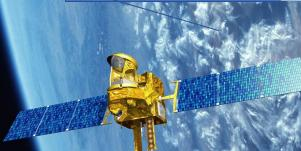
SCARAB: 4 chanels -Visible 0,5 à 0,7 μm -sun 0,2 à 4 μm -Total 0,2 à 200 μm -infrared 10,5 à 12,5 µm
