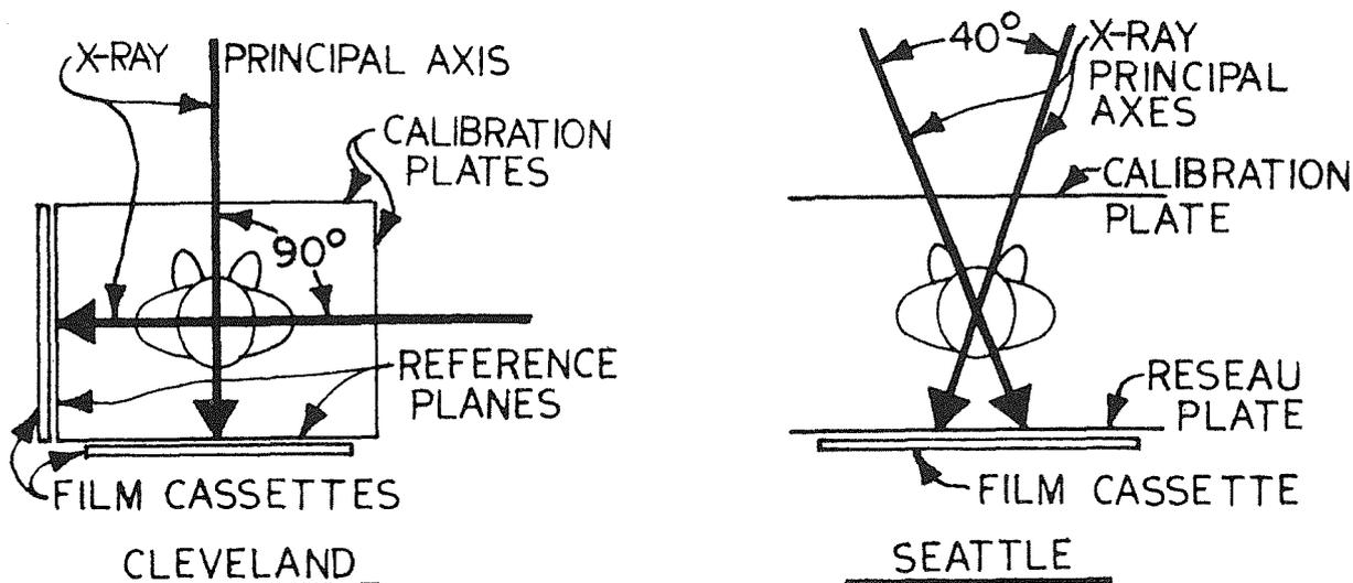
FIG.1: SYSTEM GEOMETRIES
