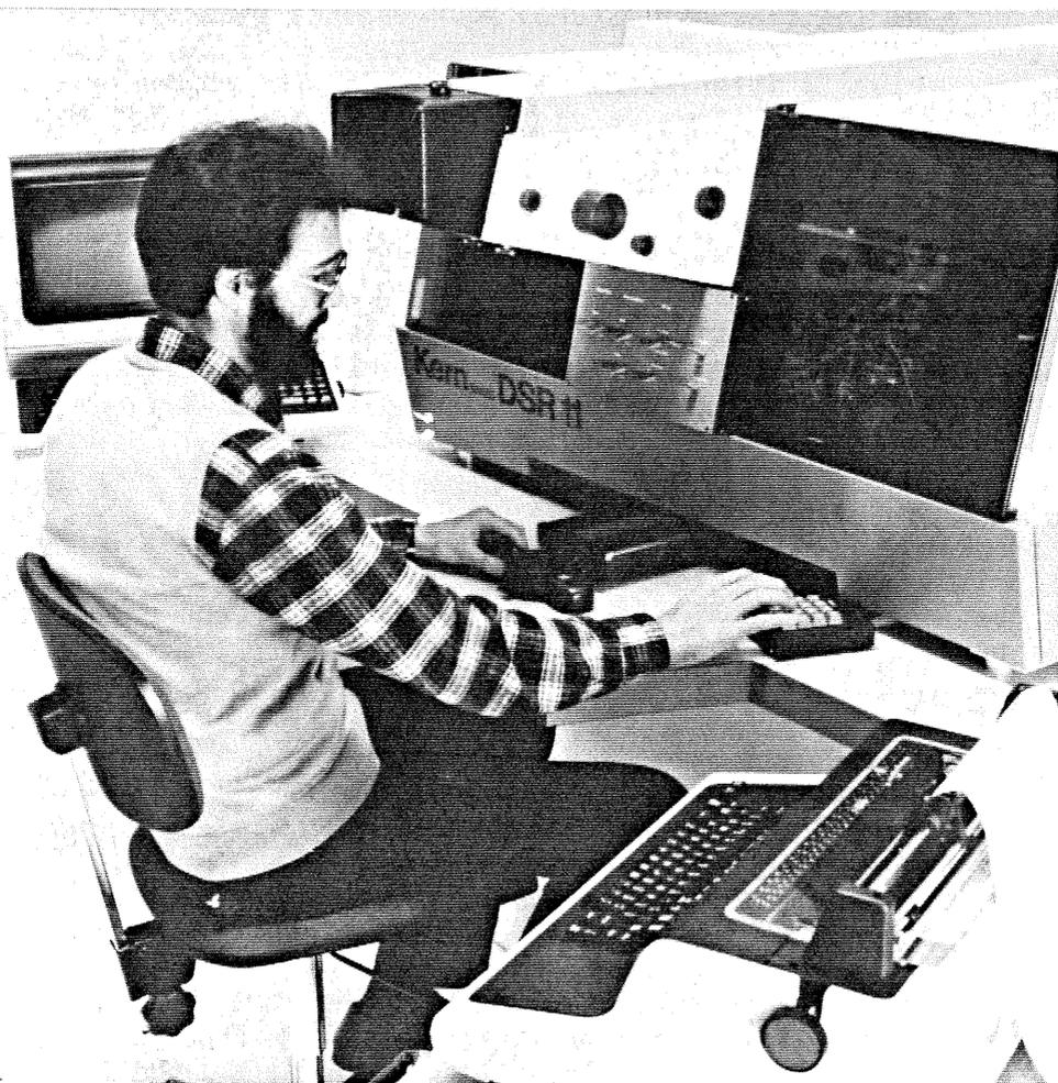
Fig. 2 Poste de commande et de contrôle du KERN DSR 11
