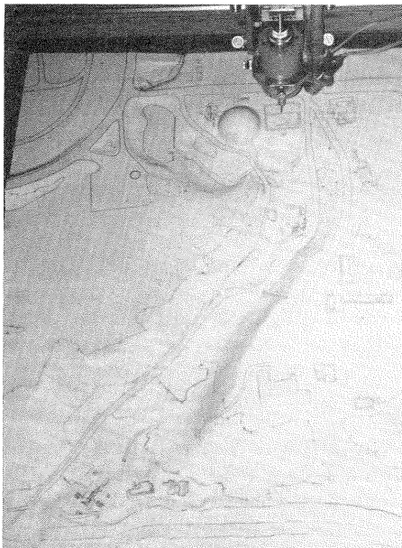
Maquette repositionnée sous le crayon traceur.
