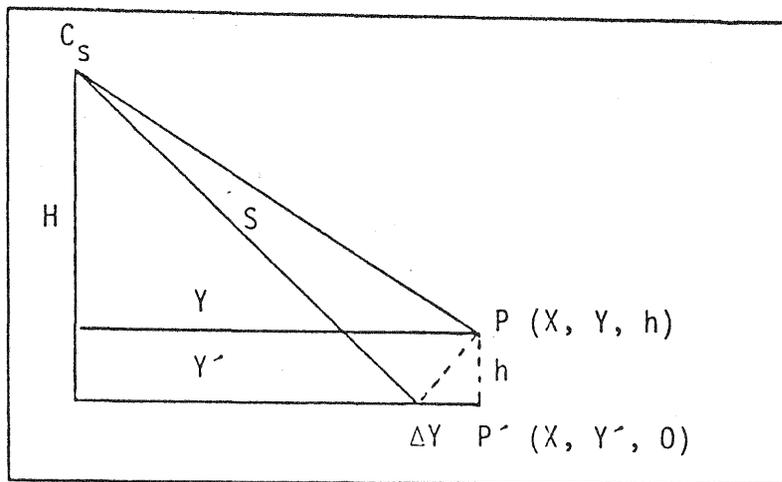
Fig. (3) Relief displacement
