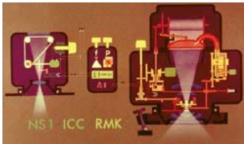
図7. 12:間隔調整コンピュータ ICC とナビゲーションセンサーNS 1 によるカメラの制御(1973)
