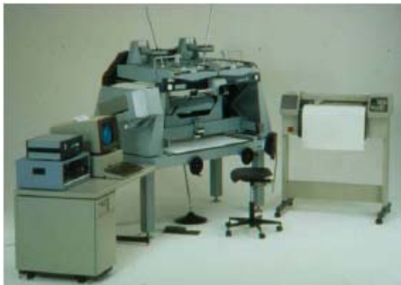
図 10. 58 :グラフィックなスーパーインポジションと HP 7580 プロッターを使ってソフトウェア支援の図化を行うプラニカート E3(1984)
