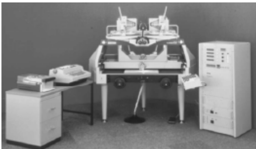
図9. 8:プラニマート D2 で IBM 製自動タイプライターと紙テープパンチ付きのエコマート 11 (1971)
