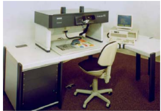
図 11. 51 :PCベースのP-CAPプログラム付きプラニコンP3(1989)
