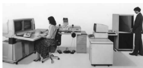
図 11. 27 : プラニコン C100 と INTERGRAPH 製ステレオデジタイザー用ワークステーションとスーパーインポジション (1983)
