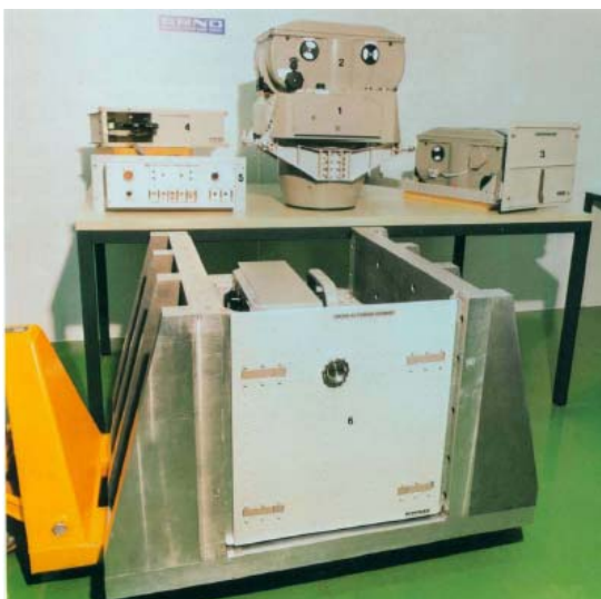
図7. 22:カメラ本体(1)、フィルムマガジン(2)、トランク入りの2台目のマガジン(3)、ケース入りのフィルター(4)、リモート制御装置(5)、カメラケース(6)
