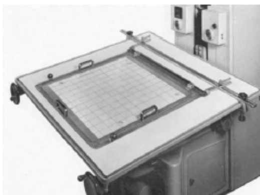
図5. 15: 格子複写装置(50cm×50cm)
