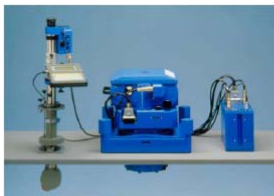
図7. 30: フィルムマガジン T-MC, ジャイロ架台 T-AS, 制御装置 T-CU, 制御パネル T-TL およびナビゲーション望遠鏡 NT 2 つきの RMK TOP の構成
