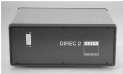
図9. 23 :座標記録装置 DIREC 2(1981)
