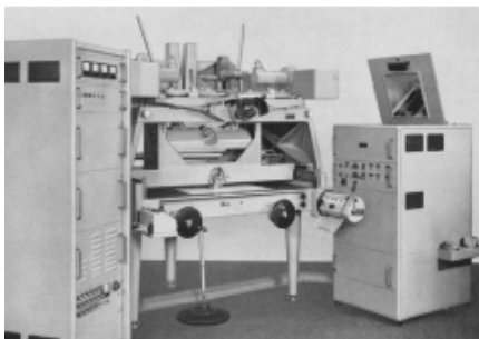
図8. 22 : 記録装置 SG 1と ITEK 製の電子スキャニング装置 EC 5 付プラニマート
