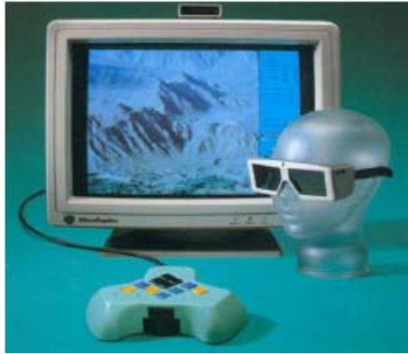
図 12. 15 :Pカーソルと立体メガネ付きの PHODIS ST
