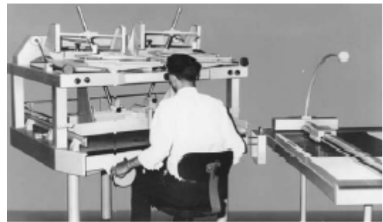
図10.15 :プラニマートと描画機EZ2の木製のモックアップ(1964)
