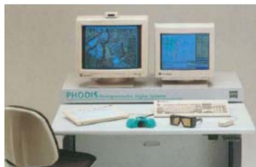
図 12. 14 :ステレオワークステーション PHODIS ST
