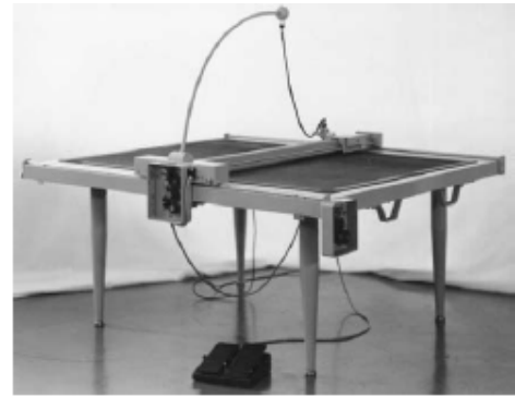
図 10. 44 : 外付け描画機 E22 (試作機 1966)
