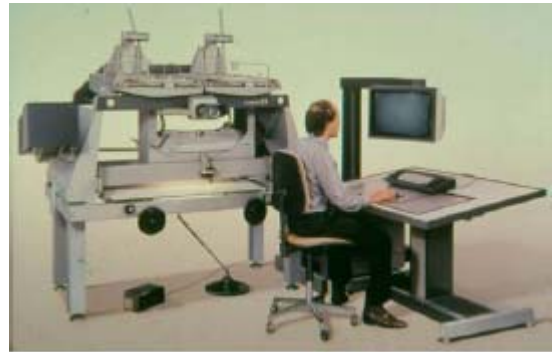
図 10. 62 :スーパーインポジション付きのプラニカート E3 と INTERGRAPH ワークステーション (1982)
