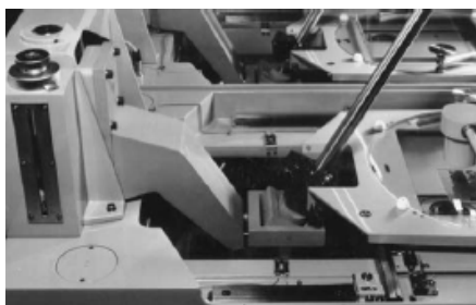
図10.22 : (地上写真の)焦点距離84 mm 以下の使用のための特注の投影カルダン
