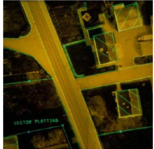
図 10. 59 :ステレオ図化機の視野の中で航空写真とビデオマップのグラフィックスのスーパーインポジション
