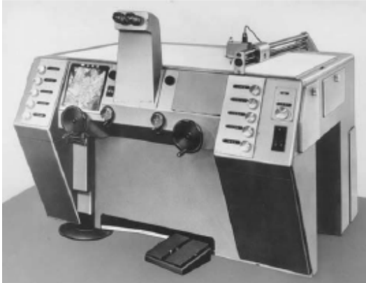
図 10. 3: 2級図化機エアロマット(1960)
