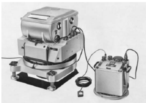
図7. 2: カメラ架台 AS II と IRU、操縦士表示器付きの RMKA 15/23
