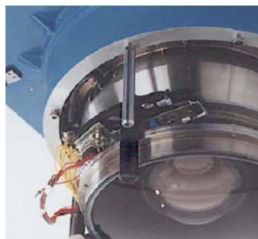
図7. 31: RMK TOP レンズコーンの傍に自動ナビゲーション装置用のセンサーヘッド
