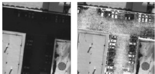
図7.43 :フィルムに対する CCD テクノロジー(10ビットの例)のダイナミック範囲の例題
