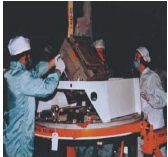
図7. 23 :SPACELAB ミッションに RMK A15/23 の組み込み
