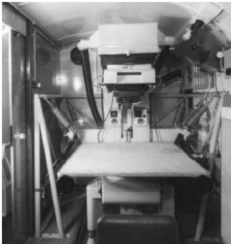
図5. 18: 支柱に取り付けたエレクトリックと標定装置 OCS 1 付き SEG 6
