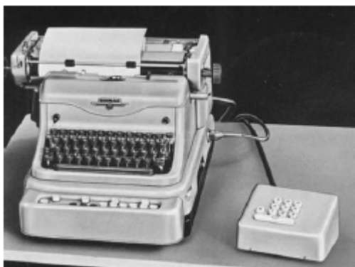
図9. 3:エコマート 1のための数値キーボード付きの 自動タイプライター
