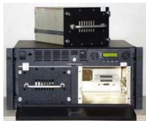
図7.48 : 第1世代の DMC 用記録装置: 各 146 GB 容量のために2個の大容量データ記録装置 MDR
