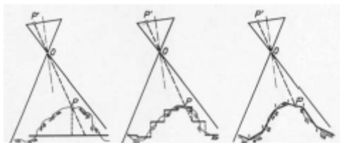
図8. 1: 偏位修正(左)、微分偏位修正(中)そして理想的な偏位修正(右)による中心投影への変換
