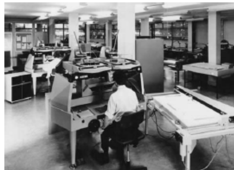
図 10. 26 : サザンプトンの英国測量局における描画機 E23 付きのプランカート E2(1973)
