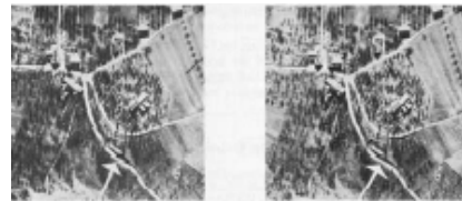
図8. 15 : 光学的な内挿による画像の改良点(不一致ありとなしの切り出し)
