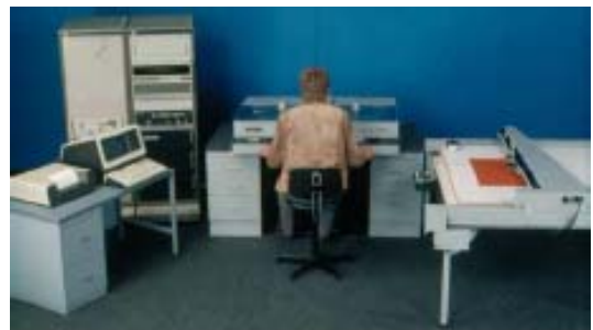
図 11. 11 : プラニコンプ C100 - 初期の構成
