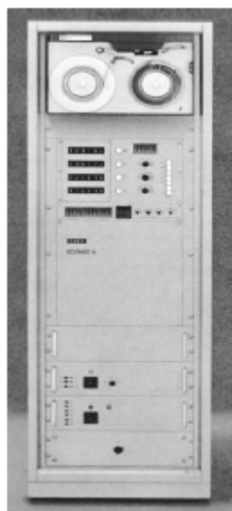
図9. 11 : 磁気テープドライブ付きのエコマート 11
