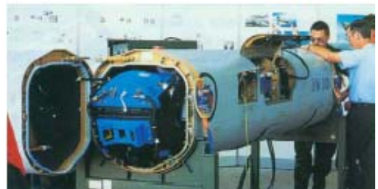
図 15. 16 : TORNADO の”偵察用ポッド”の保守
